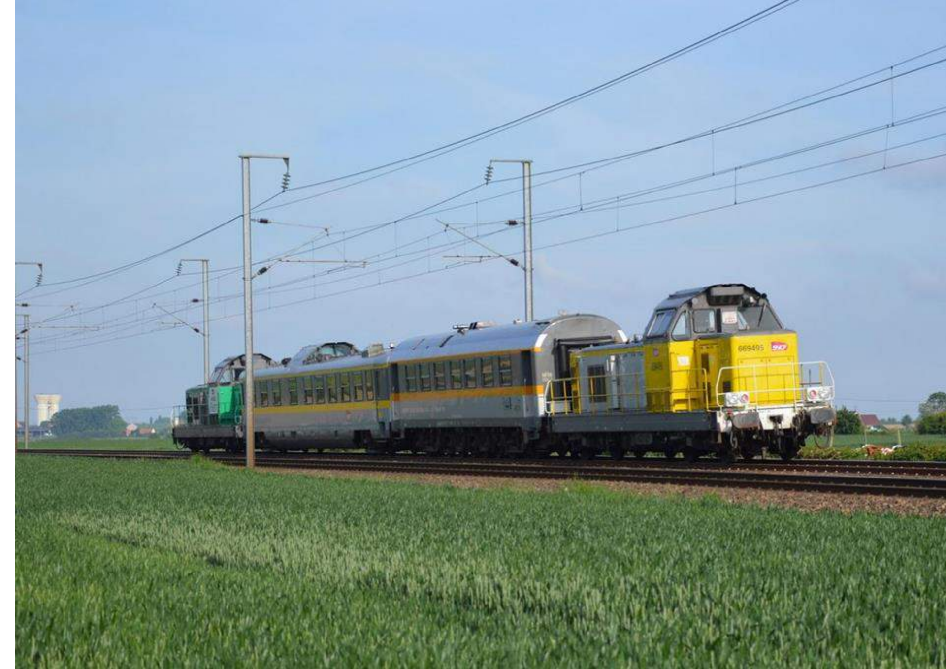
Mauzin 213 voiture de mesure de la géométrie de la voie + IES 143 voiture de mesure contrôlant la signalisation (électricité dans le rail et divers composants de signalisation), convoi encadré par 2 locomotives
