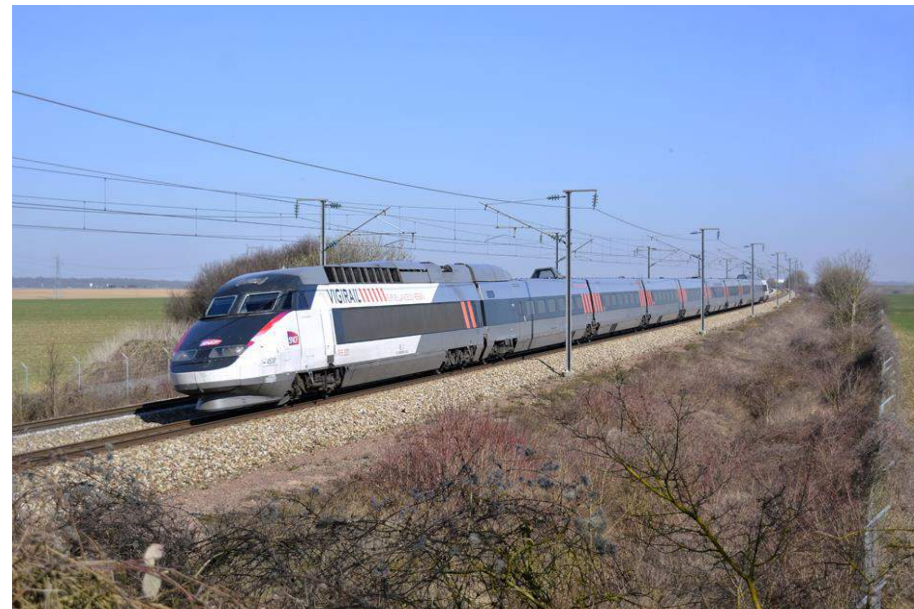
Seule rame TGV au monde à ausculter les composants de la voie ferrée à 320km/h. 5 techniciens de mesures à bord et 2 conducteurs.
