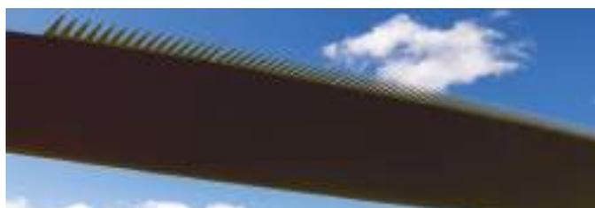
Les **serrations** permettent également de limiter la propagation du son dans l'atmosphère ce qui **réduit l'impact sonore** sur les habitations à proximité du parc éolien. Le design des serrations a été **inspiré par les ailes des chouettes**, qui ont sur ses extrémités des petits peignes qui brisent également les turbulences.
